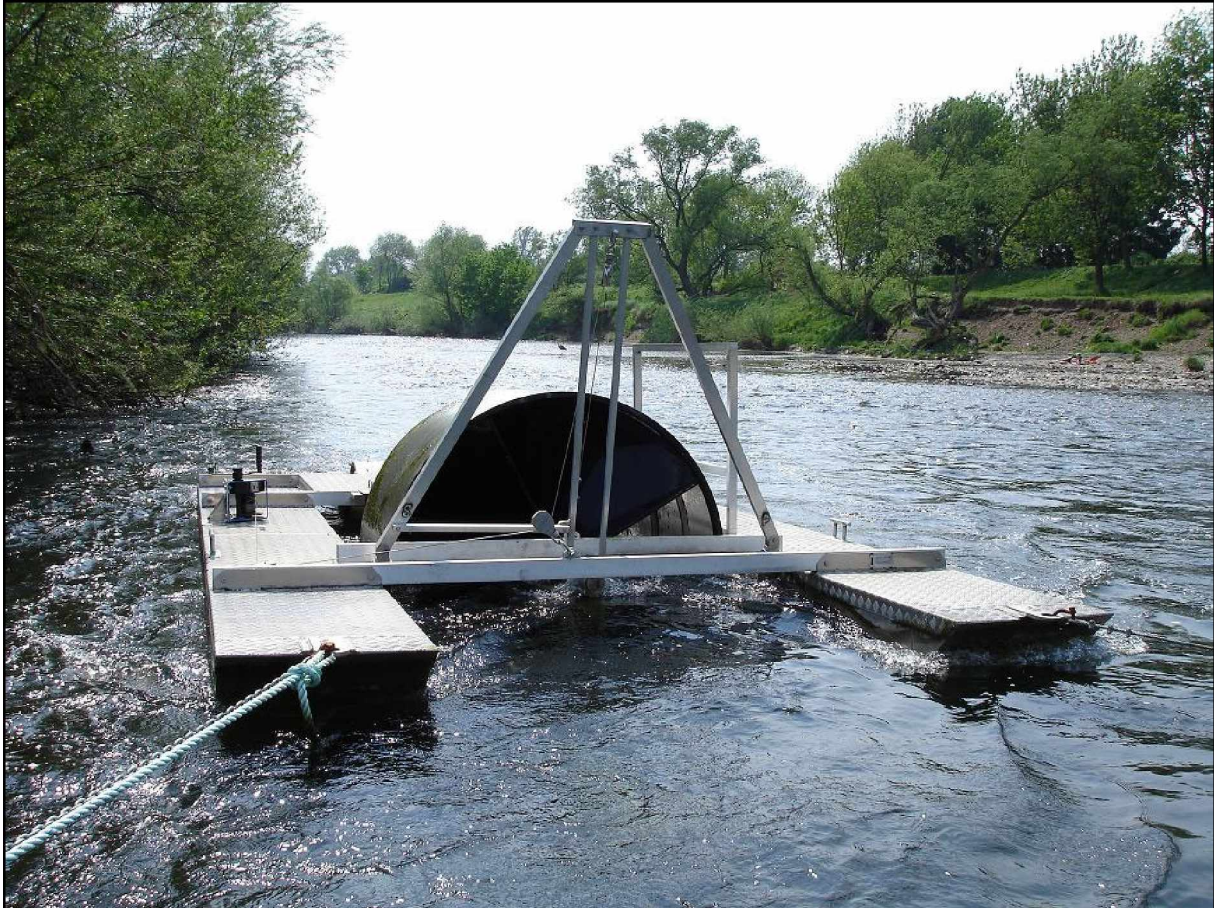
Rotary screw trap im Einsatz am Standort Buisdorf, am linken Ufer ca. 250 m unterhalb des Wehres (Foto: LimnoPlan)
