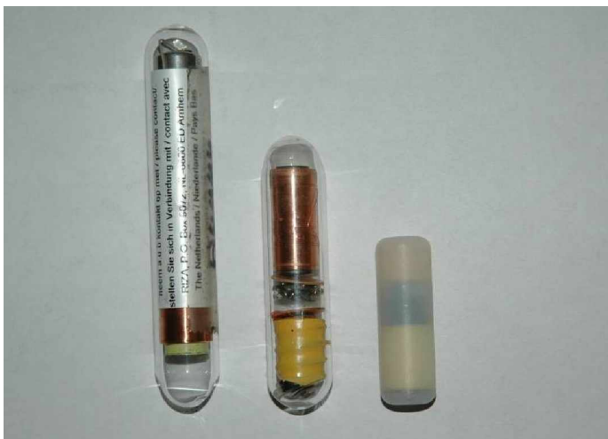
Unterschiedliche Transpondergrößen des NEDAP TRAIL system®. Der rechte Transponder wurde für die Smoltmarkierung verwendet. (Foto:VisAdvies)
