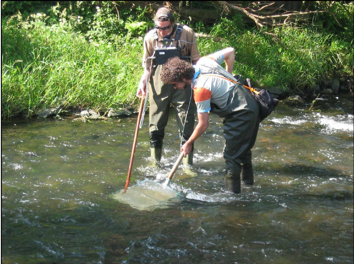
Punktbefischung unter Verwendung einer Ringnode mit Driftkescher zum Nachweis von Lachsbrütlingen (Bildquelle: J. Dirksmeyer)
