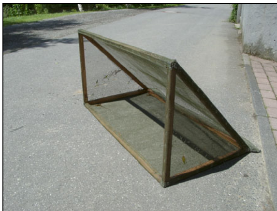
Driftnetz mit einer Innengröße von 0,5 x 1,0 m.
