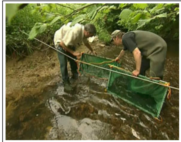
Installation der verwendeten Driftnetze mit den Abmessungen 0,5 x 1,0 m (MW 2 mm)
