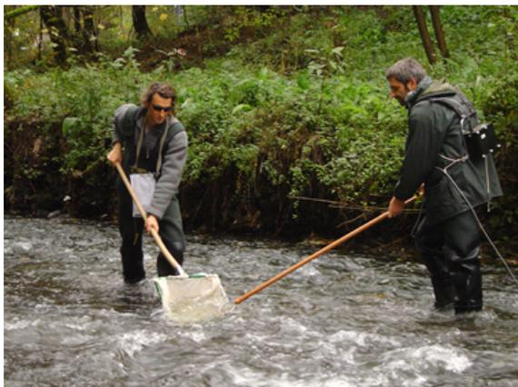
Punktbefischung unter Verwendung einer Ringanode mit Driftkescher zum Nachweis von Lachsbrütlingen
