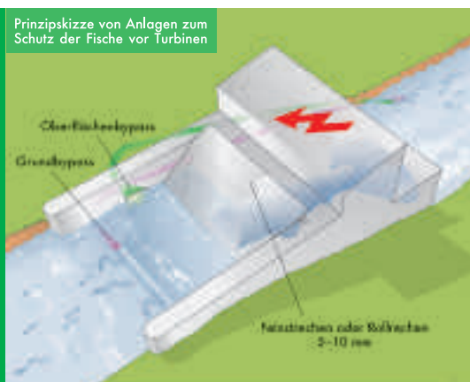
Vereinfachtes Schema einer Fischschutzanlage vor Turbinen
