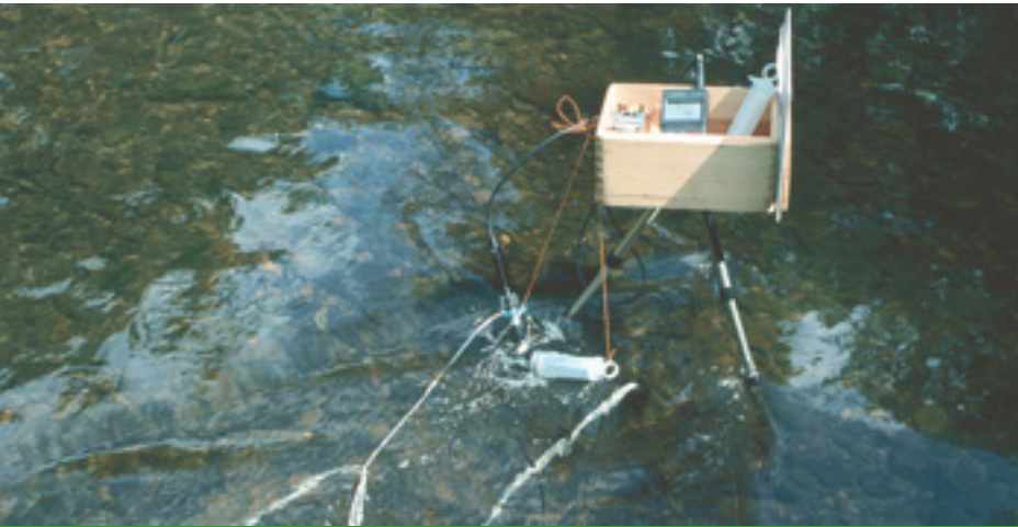
Bild 36: Messapparatur zur Registrierung der Sauerstoffgehalte im Kieslückensystem
